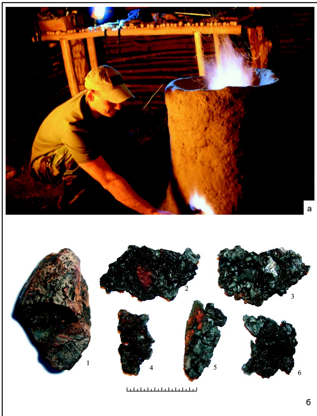
Рис. 14. Экспериментальная плавка сидеритовой руды. а — металлургический горн в процессе плавки; б — пример сидеритовой руды, загружавшейся в горн (1) и кусков металлургического шлака, образовавшегося в ходе плавки (2–6).
