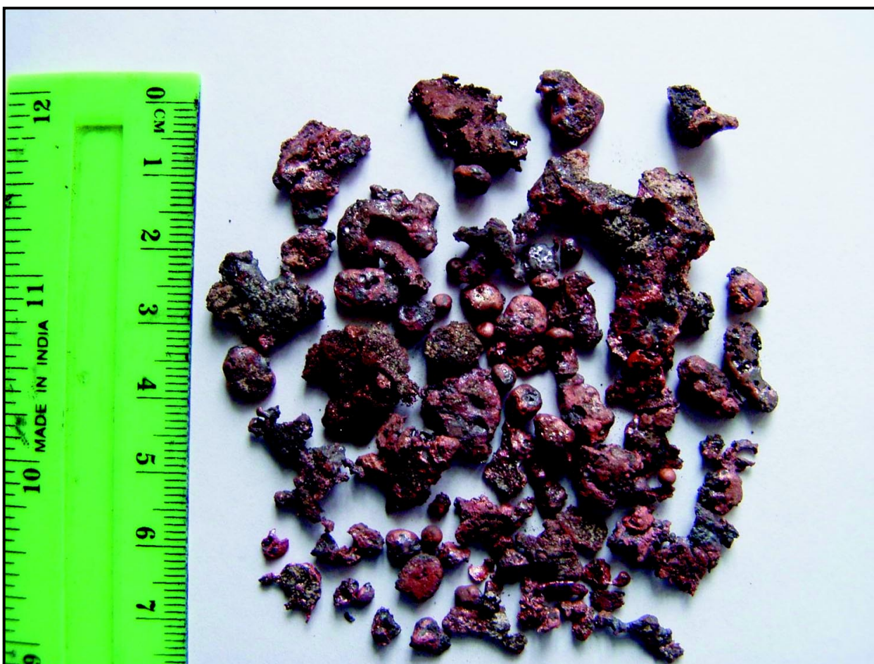
Рис. 6. Продукт металлургической выплавки сульфидной руды (эксперимент № 2 2006 г.)
