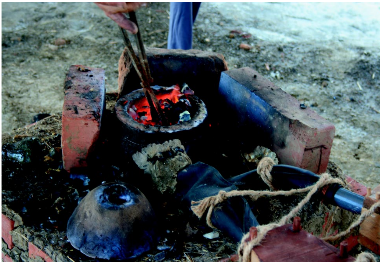
Рис. 13. Портативная плавильная печь в зоне 2 экспериментальной площадки в процессе плавки бронзы.
