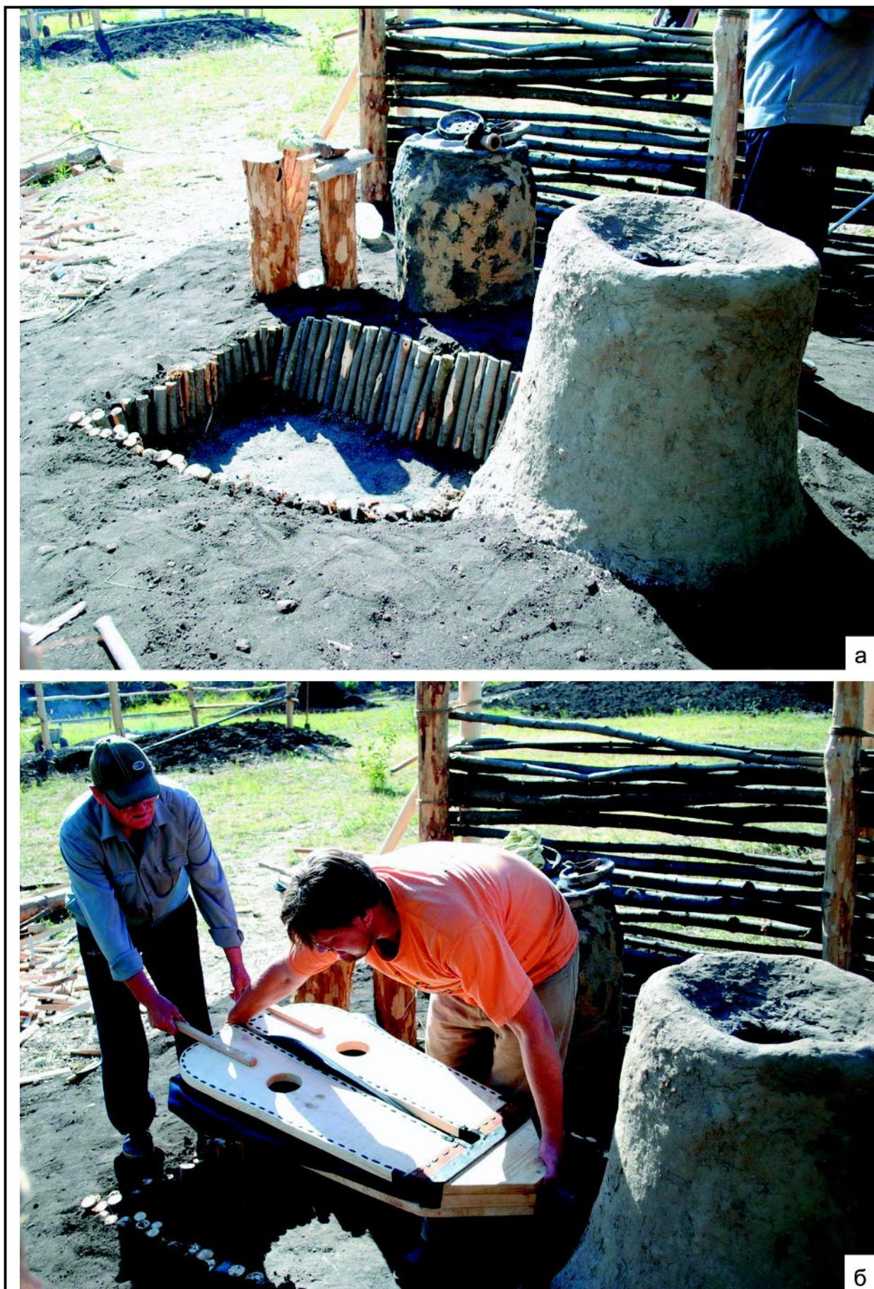
Рис. 13. Экспериментальные горны в с. Новая Беденьга в 2012 г. а — металлургический (на переднем плане) и кузнечный (на заднем плане) горны, построенные участниками археологической экспедиции 2012 г. в с. Новая Беденьга под руководством Ю.А. Семькина. б — авторы статьи в процессе установки воздуходувных мехов для металлургического горна.
