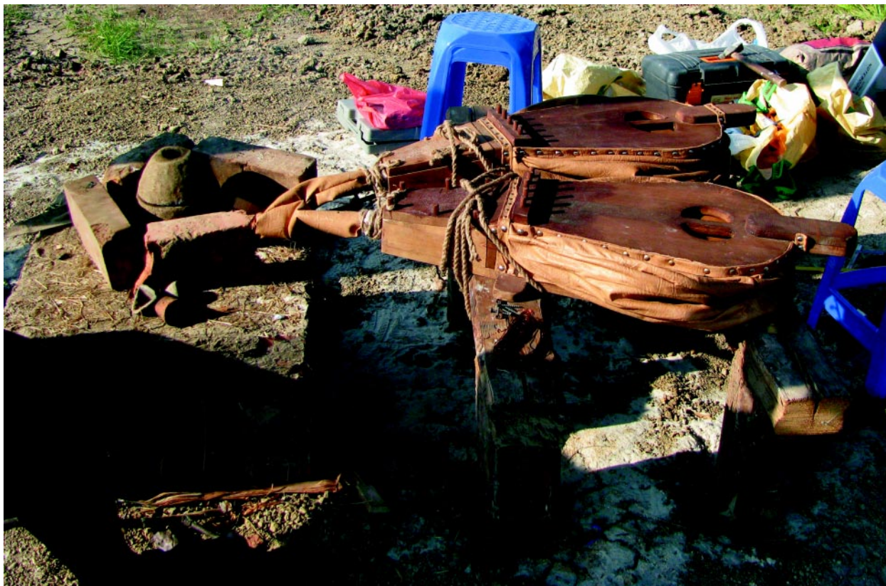
Рис. 12. Однокамерные мехи и портативная плавильная печь в зоне 2 экспериментальной площадки.
