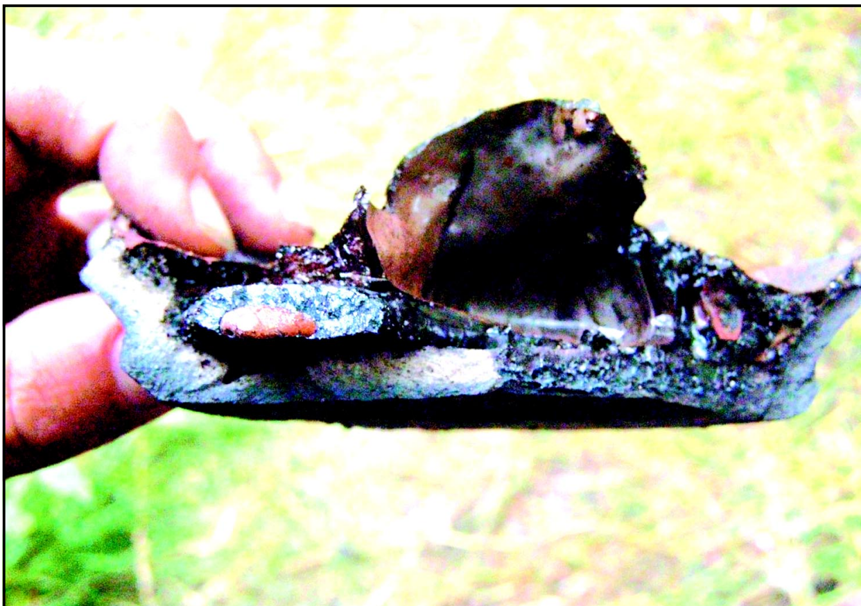
Рис. 9. Результат металлургического передела сульфидной руды в плавильной чаше (эксперимент № 2 2007 г.)
