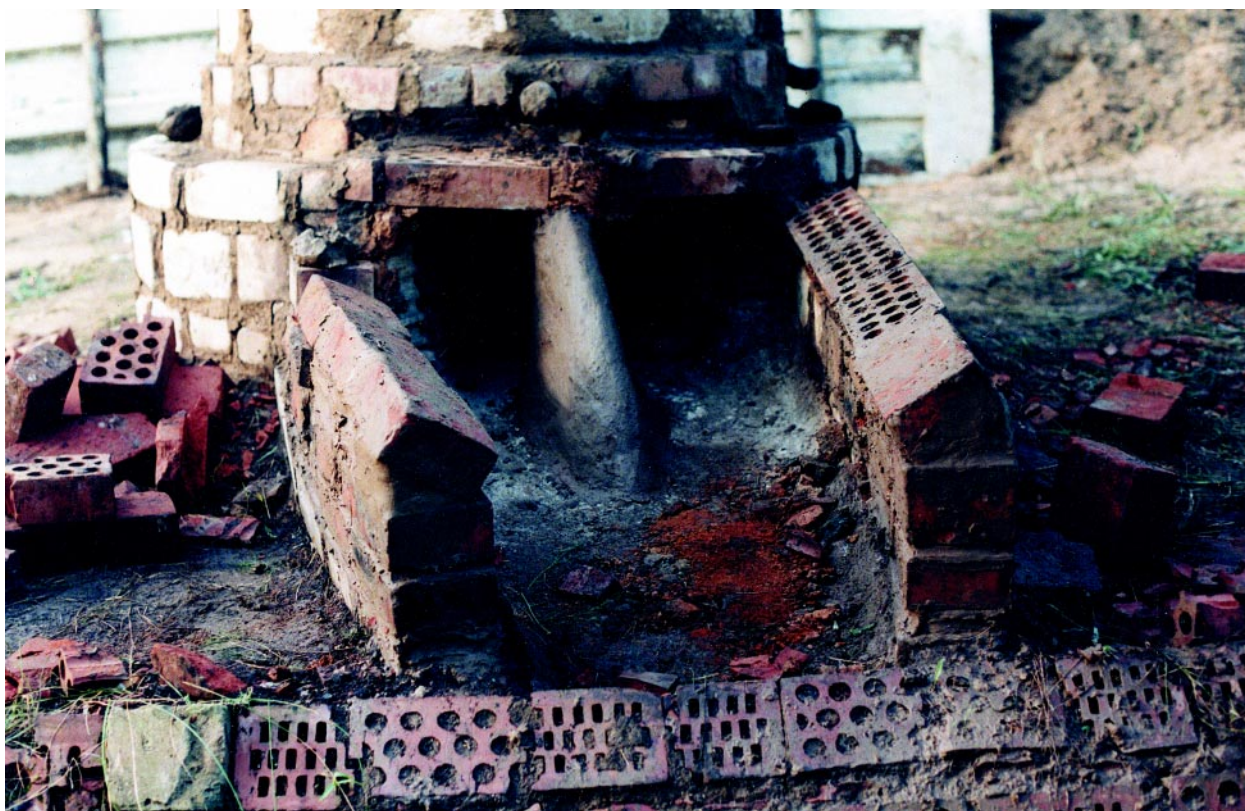
Илл. 5. 1–2. Эксперимент по обжигу глиняной посуды в Самарской экспедиции по экспериментальному изучению древнего гончарства. строительство кирпичного наземного горна (2000 г.). 1 — создание платформы из щебня и глины перед строительством горна; 2 — вид на устье горна и рассекатель пламени.
