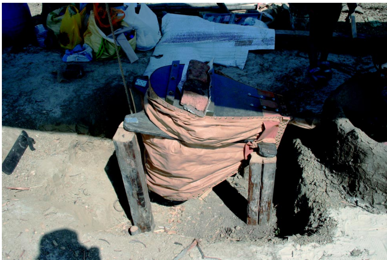
Рис. 3. Зона 1 экспериментальной площадки, большой двухкамерный мех непрерывного дутья.
