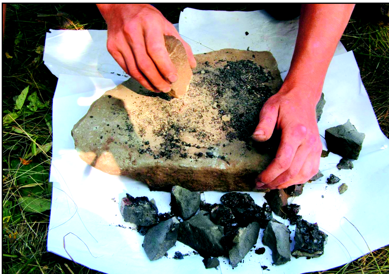
Рис. 7. Процесс дробления шлака (эксперимент № 1 2007 г.)
