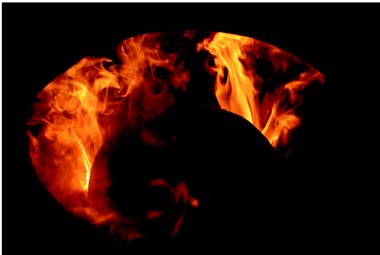
Рис. 6. Финал этапа прогрева определялся по регулярности проникновения языков пламени в обжиговую камеру через отверстия колосников-продухов. Наилучший результат — стабильное горение во всех отверстиях полки
