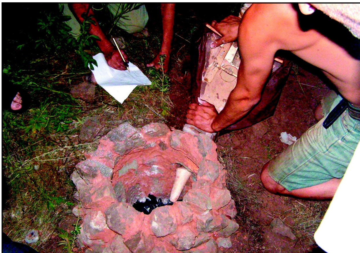
Рис. 11. Выплавка сульфидной руды с использованием экспериментального инструментария (эксперимент № 2 2009 г.)
