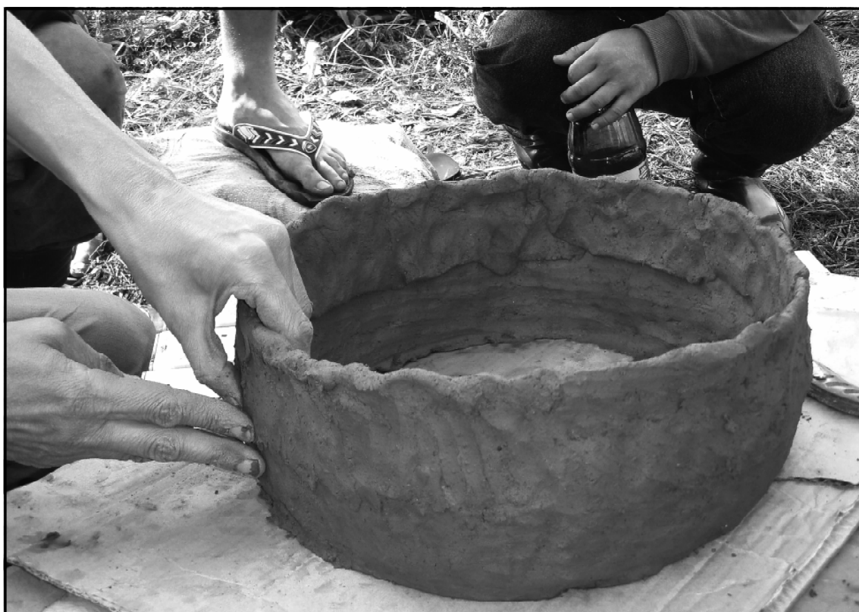
Рис. 4. Примазывание глиняных лент с внешней стороны емкостного начина.
