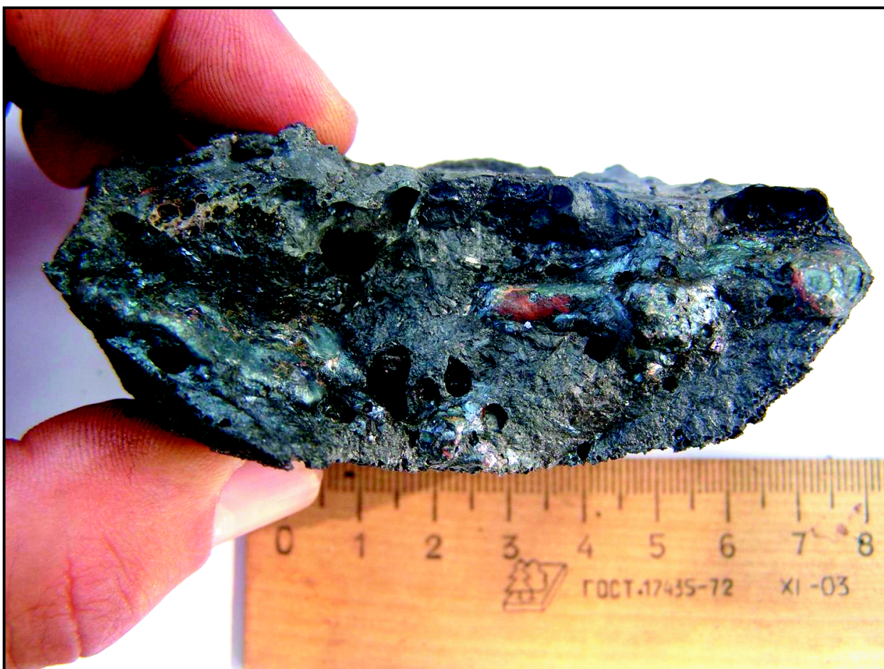
Рис. 10. Результат металлургического передела сульфидной руды в плавильной чаше (эксперимент № 1 2008 г.)
