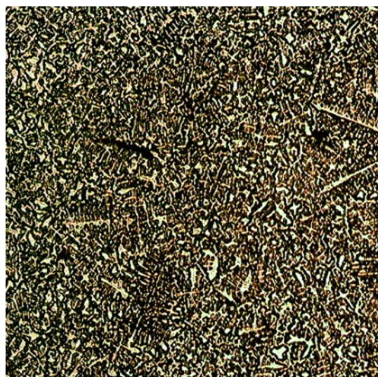
Фото 1. Микрофотографии. Эталон отлитый в форму из глины. а — 316а (спектр 705а, зона А), увеличение микроструктуры 80, охлаждение отливки на воздухе; б — 316б (спектр 705б, зона В), ув. 80, охлаждение отливки на воздухе; в — 317а (спектр 706а, зона А), ув. 80, охлаждение отливки в воде; г — 317б (спектр 706б, зона В), ув. 80, охлаждение отливки в воде.
