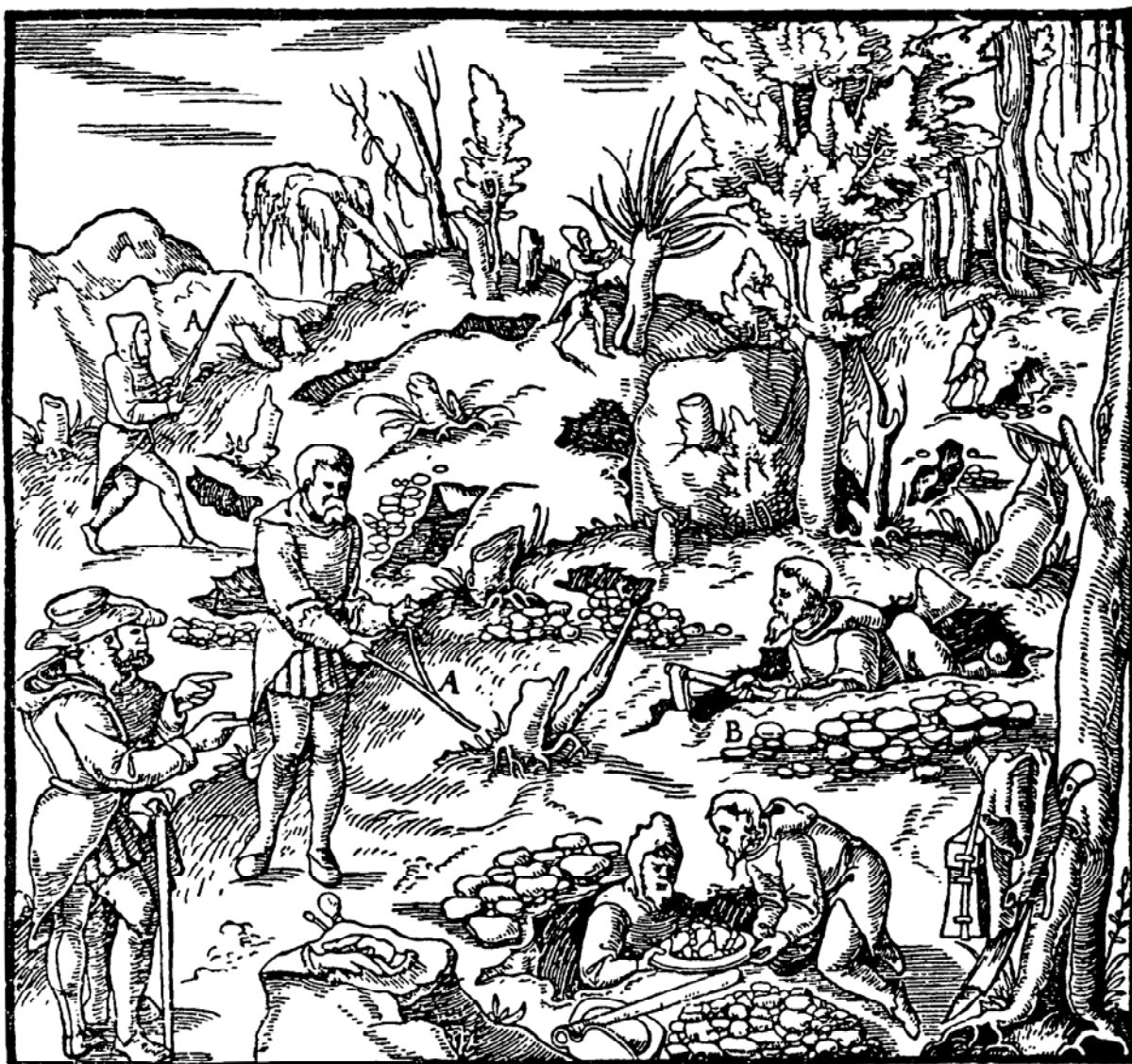
Рис. 15. Поиск рудных жил в эпоху средневековья (по: Агрикола 1962. С. 55). А — рудоискательская лоза, В — шурф.
