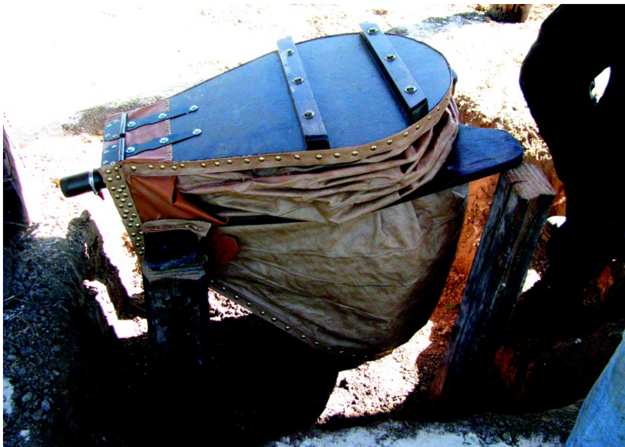
Рис. 2. Зона 1 экспериментальной площадки, большой двухкамерный мех непрерывного дутья.
