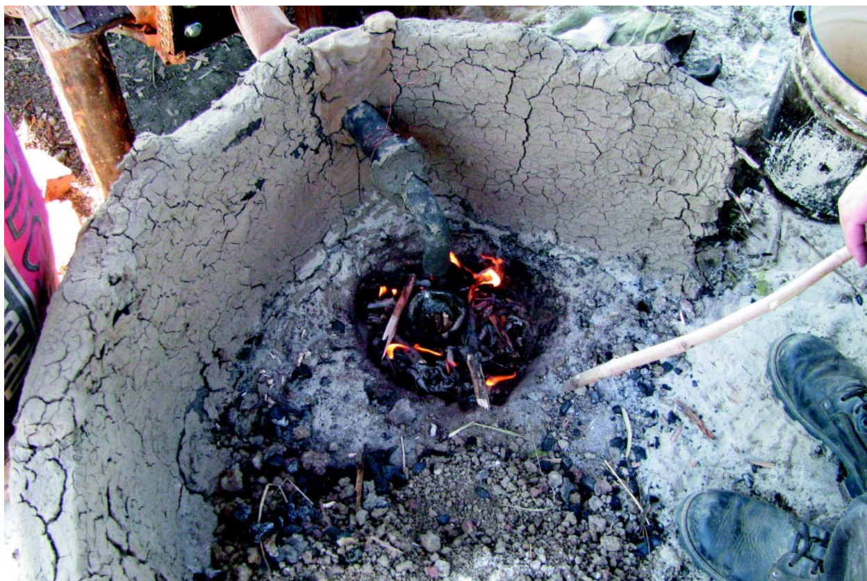
Рис. 6. Начальный этап плавки бронзы в зоне 1 экспериментальной площадки.
