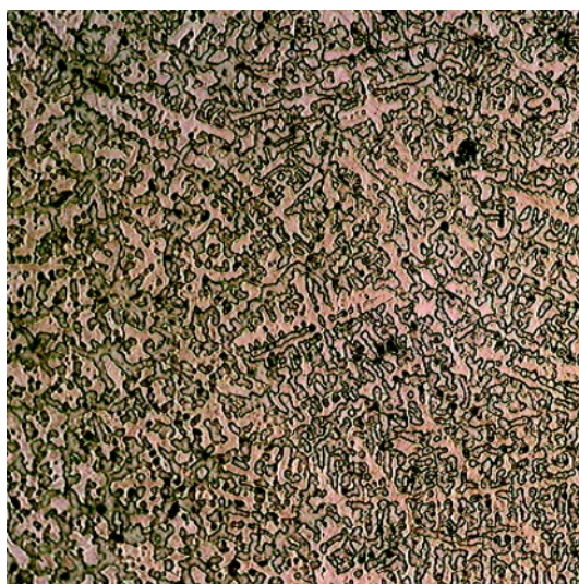
Фото 1. Микрофотографии. Эталон отлитый в форму из глины. а — 316а (спектр 705а, зона А), увеличение микроструктуры 80, охлаждение отливки на воздухе; б — 316б (спектр 705б, зона В), ув. 80, охлаждение отливки на воздухе; в — 317а (спектр 706а, зона А), ув. 80, охлаждение отливки в воде; г — 317б (спектр 706б, зона В), ув. 80, охлаждение отливки в воде.
