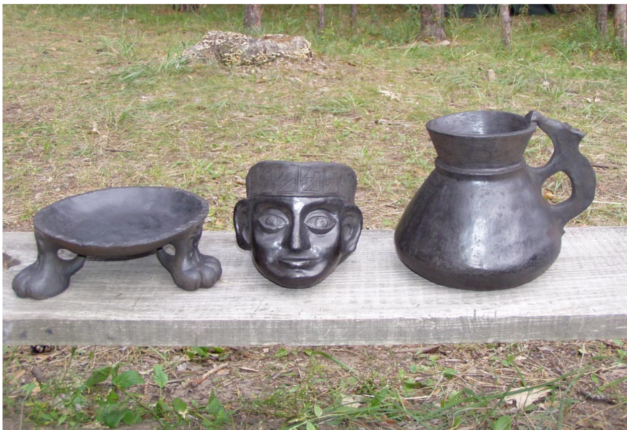
Илл. 7, 5–6. Эксперимент по обжигу глиняной посуды в Самарской экспедиции по экспериментальному изучению древнего гончарства. 5 — сосуды и поделки, обожженные в гончарном горне в условиях окислительной атмосферы; 6 — сосуды и поделки, обожженные в гончарном горне в условиях восстановительной атмосферы.
