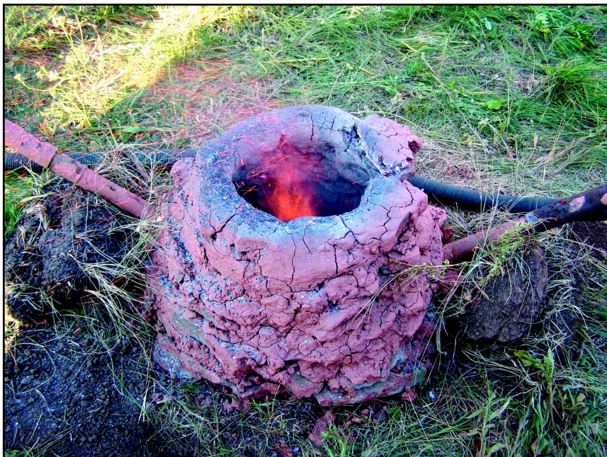
Рис. 2. Экспериментальная печь конусовидной формы (картамышский тип)
